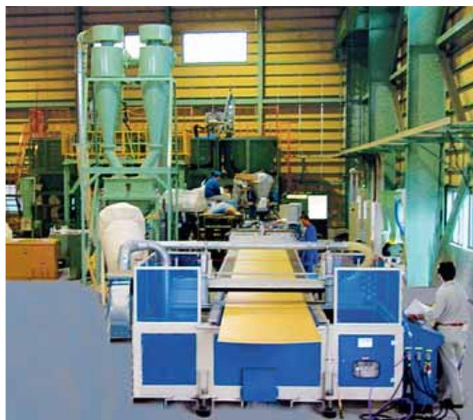
Рис. 1. Установка по производству листов и панелей из ДПКТ на базе экструдера компании Hans Weber Maschinenfabrik GmbH (Германия) и инструментов фирмы Pro Poly Tec GmbH
